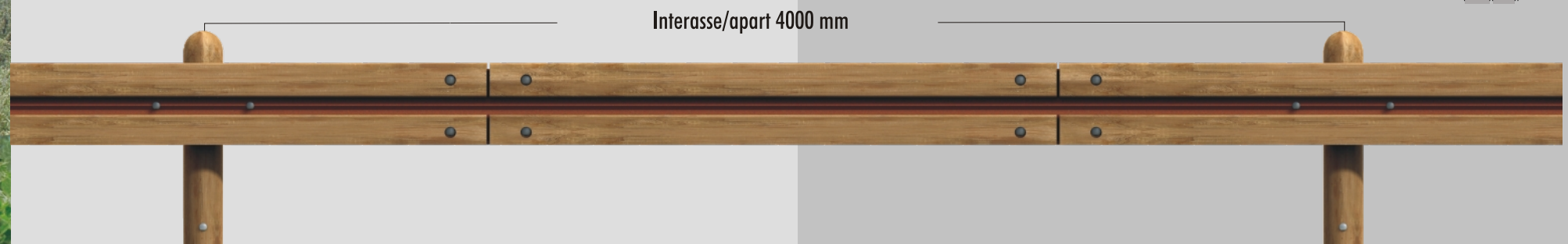
▲ Elemento modulare della barriera - Barrier module
